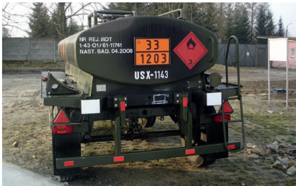
Fot. 3. Oznakowanie części tylnej cysterny typu CP-4 na podwoziu przyczepy D-46
