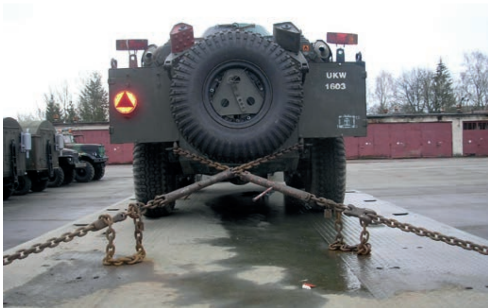
Fot. 6. Zabezpieczenie łańcuchami ściąagającymi pojazdu przewożonego zestawem niskopodwoziowym
