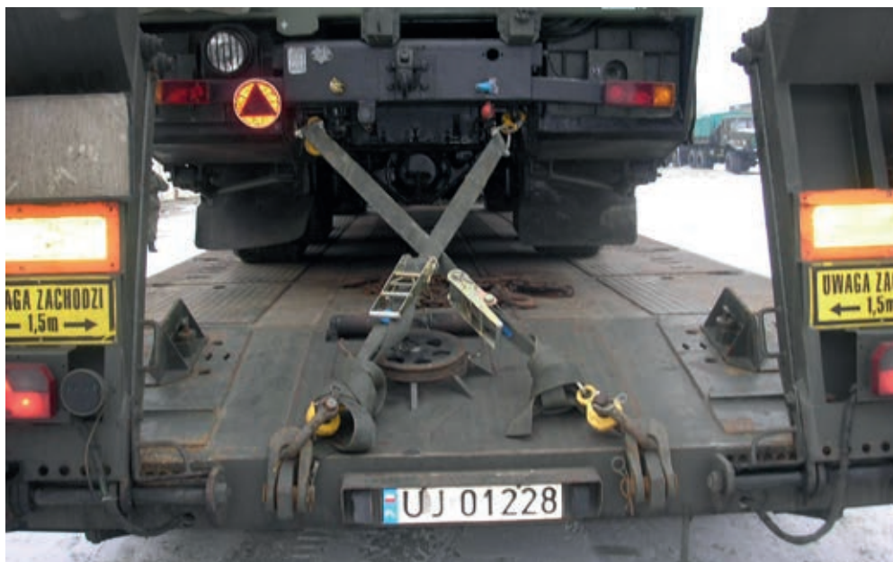
Fot. 7. Wariant mocowania pojazdu za pomocą transportowych pasów ściągających
