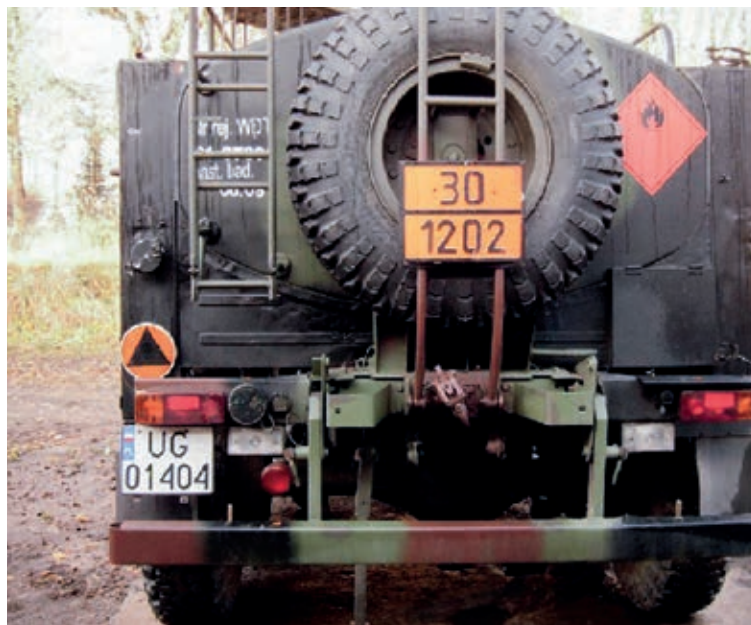
Fot. 2. Oznaczenie tylne autocysterny typu CD-4,5 m 3 na podwoziu pojazdu Star 266
