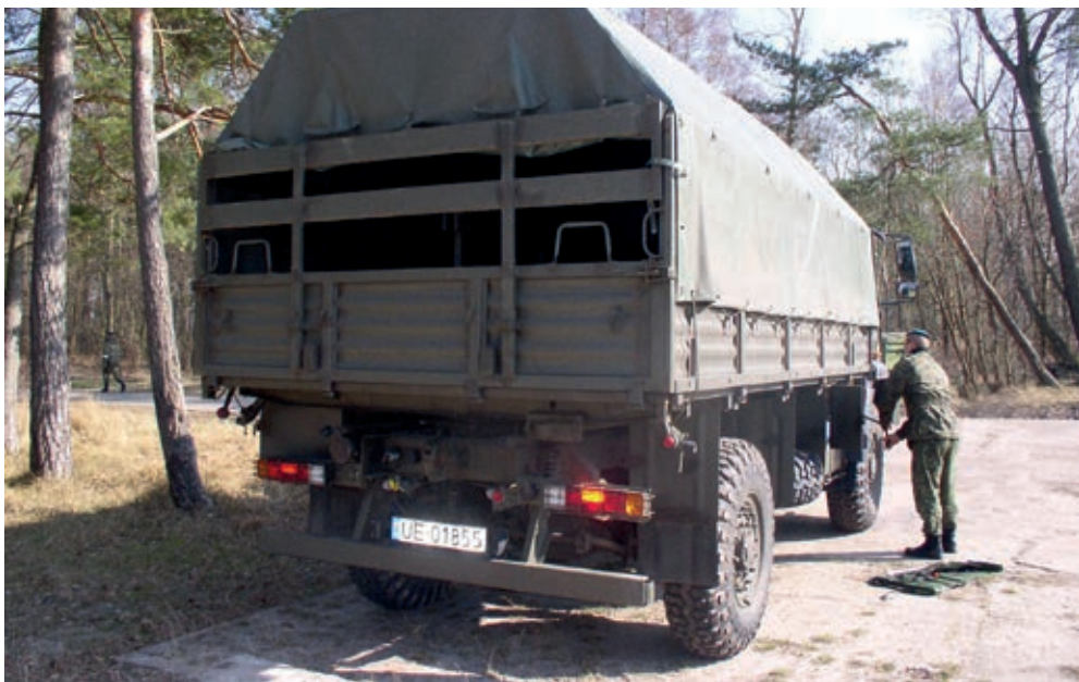
Fot. 1. Zabezpieczenie przewożonych żołnierzy za pomocą burty wraz z dodatkową burtą wsuwaną w jej mocowanie
