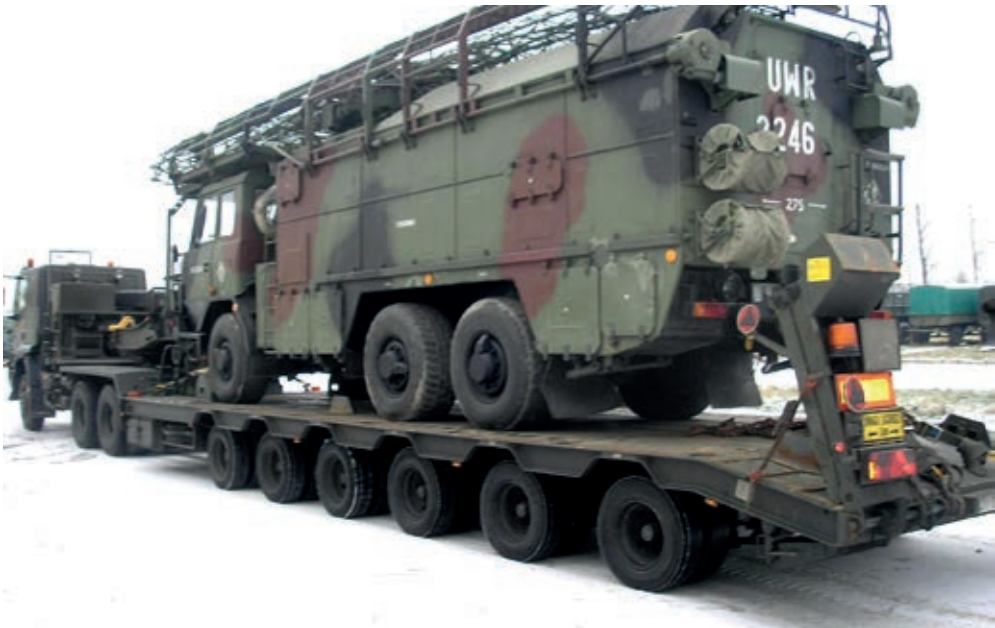
Fot. 8. Zabezpieczenie pojazdu specjalnego typu Tatra 815 NUR przewożonego zestawem niskopodwoziowym
