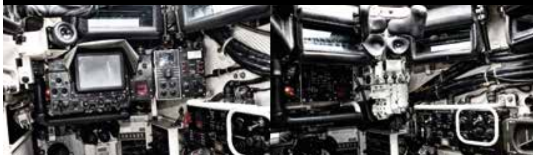
Stanowisko dowódcy. W wersji A5 (z lewej) pojawił się centralny pulpit obsługi TIM wyposażony w monitor. Zespół łączący główkę dziennego celownika PERI z okularzem przeniesiono na lewą stronę tego stanowiska. W wersji A5 pojawił się centralny pulpit obsługi systemu GPS.
