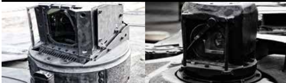
Porównanie głowic przyrządów celowniczo-obszaryjnych PERI R17. Z lewej w wersji A2, z kamerą termalną – modulem TIM. Z prawej wersja A1 bez kamery termalnej w wyraźnie mniejszych rozmiarach.
