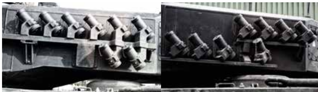
Stelaże wyrzutni granatów dymnych. Z lewej zmodyfikowany układ wersji A5 – sześć granatów na górze stelażu, dwa na dole. Z prawej wersja stosowana w A4.
