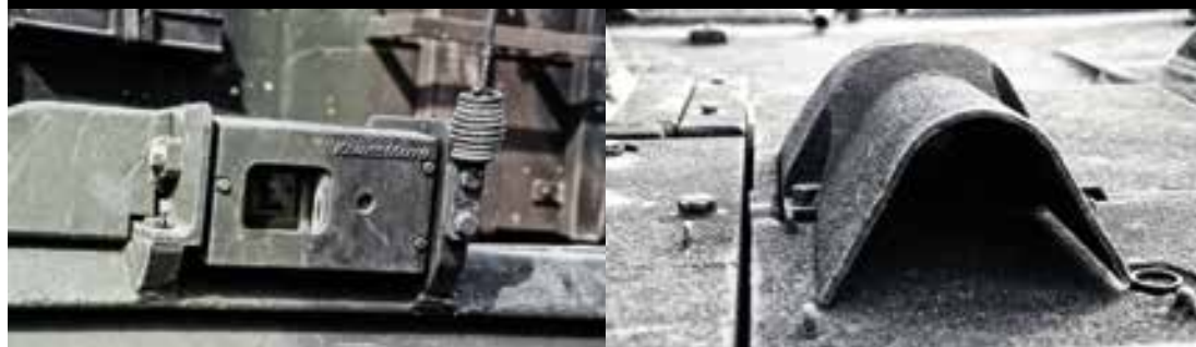
Detale wersji A5. Widoczna osłona celownika awaryjnego FERO Z18A2 (z prawej) i kamera cofania (z lewej), wyposażona w przesuwaną osłonkę do czyszczenia okularu.
