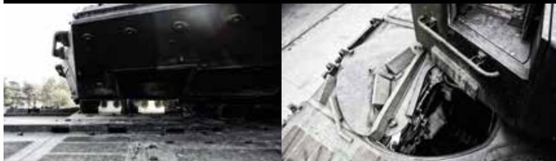
Właz kierowcy w wersji A4 otwierał się przez podniesienie i obrót (z prawej). W wersji A5 nie unosi się, lecz przesuwa od razu w bok (z lewej) – właz od czoła, w położeniu zamkniętym.
