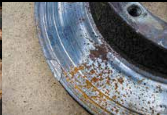
Fot. 2. Korozja tarczy hamulcowej
