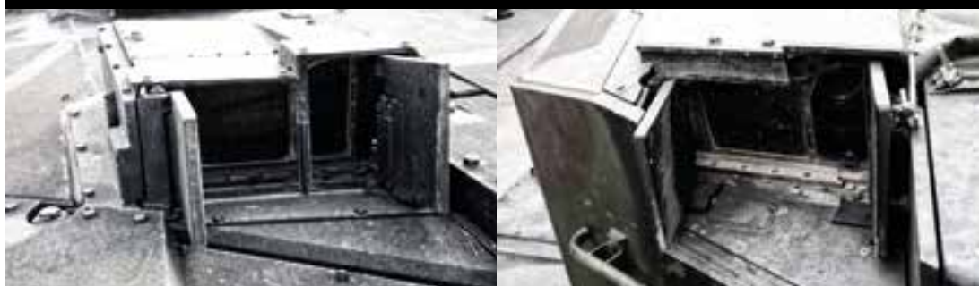
Porównanie aranżacji celownika działonowego EMES-15 na wieżach wersji A5 (z lewej) i A4 (z prawej).
