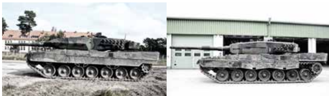
Sylwetka Leoparda 2A5 (z lewej) i Leoparda 2A4 (z prawej). Profil wieży w wersji A5, mającej dodatkowe opancerzenie, wyraźnie inny niż w Leopardzie 2A4.
