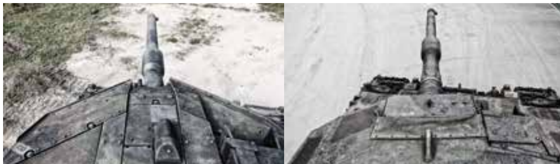
Przednia część wieży widoczna od góry. W wersji A5 (z lewej) ma trapezowy kształt, a strop pokryty wykładziną przeciwpoślizgową. Na osi lufy widoczna osłona celownika awaryjnego FERO Z18A2. W tym miejscu w wersji A4 (z prawej) znajduje się zaczep.
