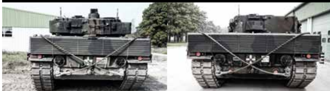
Czołgi widoczne od tyłu. W wersji A5 (z lewej) na wieży charakterystyczne dodatkowe kosze na wyposażenie. Wyraźnie wyróżnia się główka celownika PERI R17A2/TIM przesunięta bardziej do tyłu niż w wersji A4. Na kadłubie kamera cofania.
