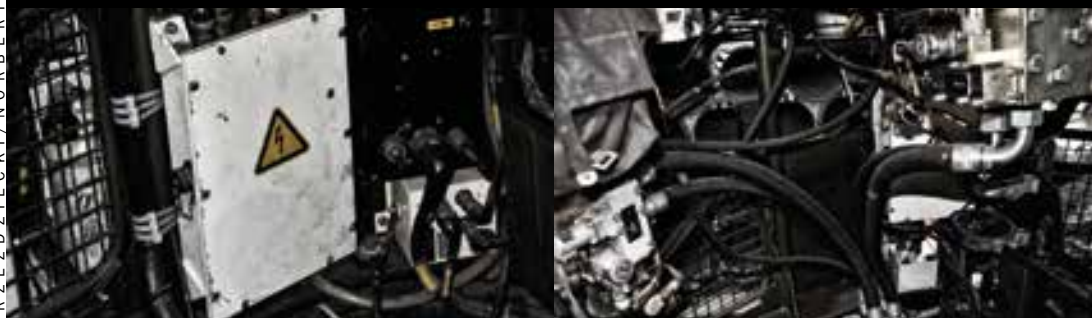
Detale układu naprowadzania i stabilizacji uzbrojenia. W wersji A4 (z prawej) przewody napędu hydraulicznego. W wersji A5 zrezygnowano z niego na rzecz układu elektrycznego (z lewej).
