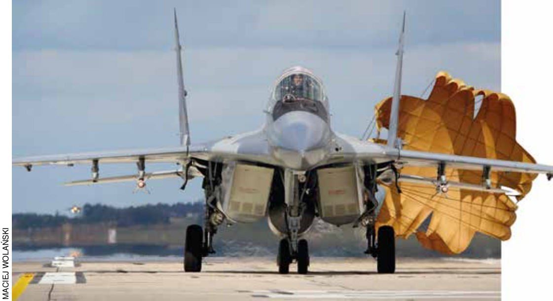
FOT. 4. MiG-29 skraca drogę lądowania przez otwarcie spadochronu hamującego
