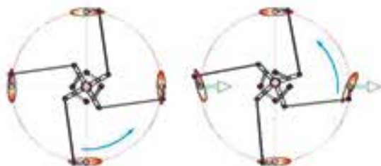
Rys. 3. Położenie łopatek przy biegu luzem i przy wytwarzaniu siły naporu
