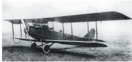
Fot. 1. Curtiss JN-4 – dwupłatowiec, którego tylny kokpit był wykorzystywany do transportowania rannych
