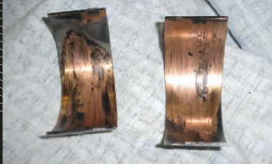
Fot. 1. Zniszczone półpanewki
