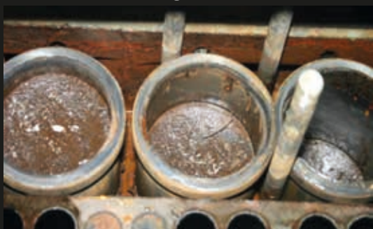
Fot. 5. Widok uszkodzeń silnika S-47
