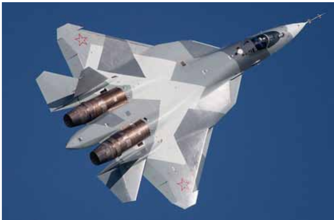
FOT. 1. SUCHOJ PAK FA od góry. Dobrze widoczne proporcje i ułożenie silników względem płatowca
