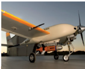
TESTOWANY POCISK STM podwieszony pod kadłubem samolotu Cobra
