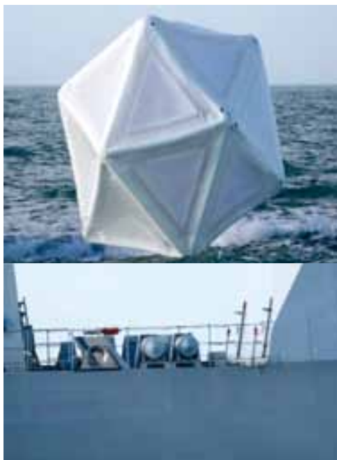
FOT. 5. WYRZUTNIA NA OKRĘCIE szybko rozkładających się zestawów odbijaczy kątowych IDS 300 oraz odbijacz
