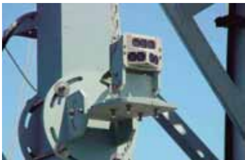
FOT. 1. SENSORY OSTRZEGAJĄCE o promieniowaniu wiązka laserową firmy SAAB
