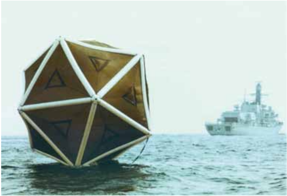
FOT. 6. PASYWNY ŚRODEK walki elektronicznej rozmieszczony poza okrętem
