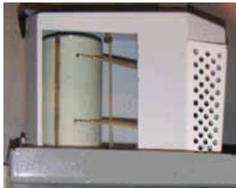
FOT. 1. PRZYRZĄD do pomiaru wilgotności względnej powietrza
