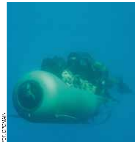
FOT. 3. HOŁOWNICZY POJAZD PODWODNY w trakcie transportowania pletwonurków w rejon działania
