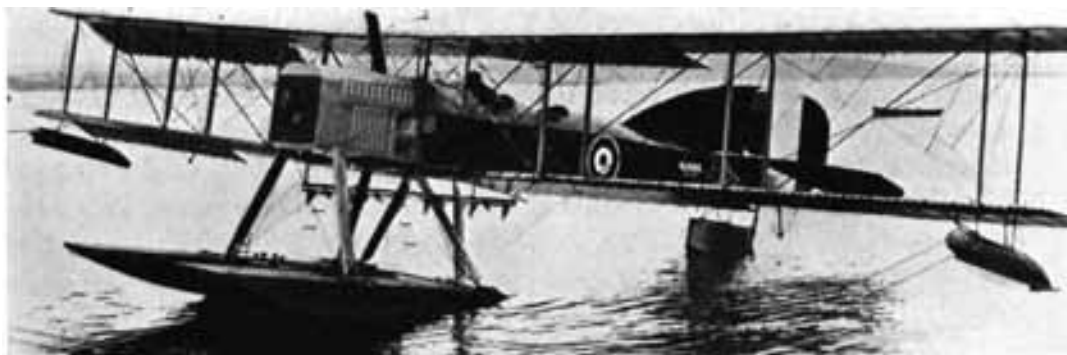
FOT. 1. WODNOSAMOLOT TYPU SHORT 184 DOVER nr 1098 z silnikiem typu Sunbeam o mocy 260 KM z chłodnicą czołową
