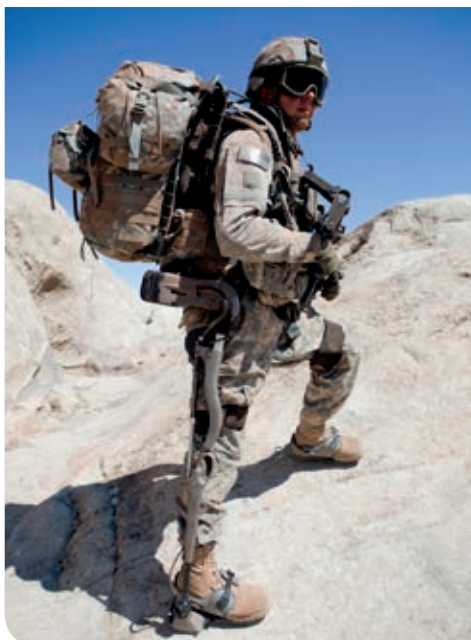
Fot. 2. Egzoszkielet HULC stworzony na Uniwersytecie Kalifornijskim w Berkeley pod kierunkiem prof. H. Kazeroonięgo
