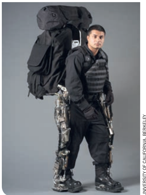
Fot. 1. Egzoszkielet BLEEX stworzony na Uniwersytecie Kalifornijskim w Berkeley pod kierunkiem prof. H. Kazeroonię
